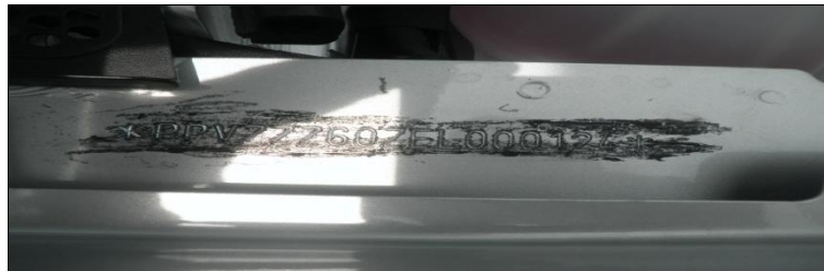
Contoh Gambar No Casis Yang Betul Di Cop Pada Rangka Casis Bahagian Dalam Kenderaan
